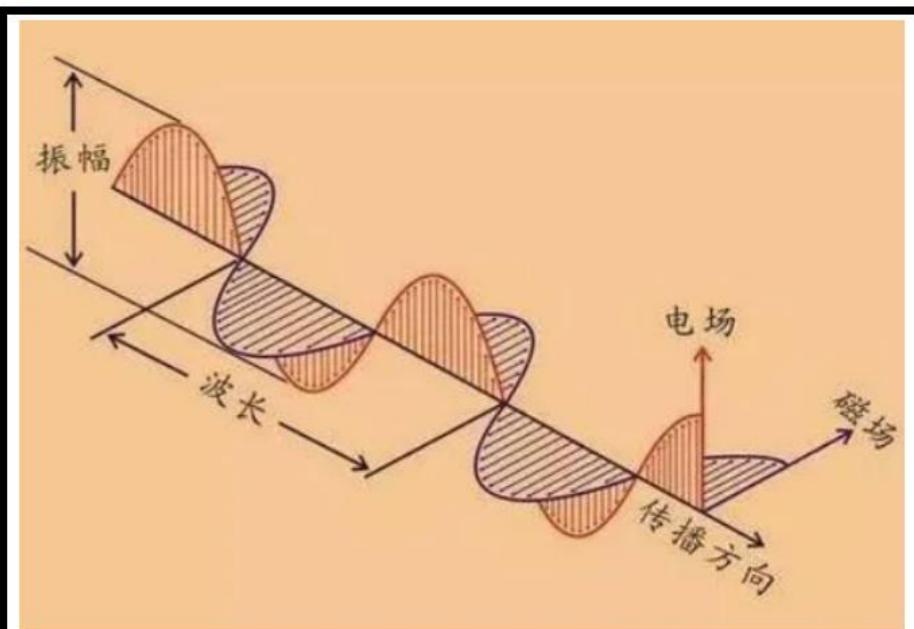
图六：变化的电场与磁场相互激励形成电磁波示意图
